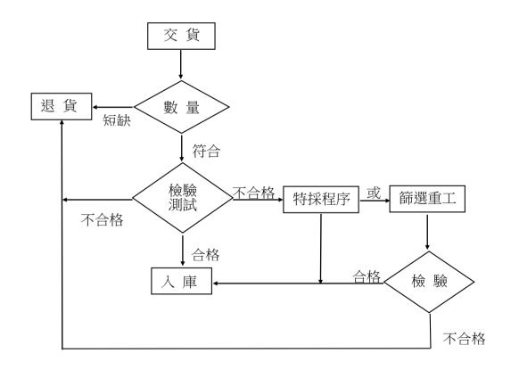
圖 1 進料檢驗作業程序範例
